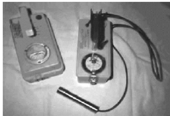
Figura 1 - À esquerda esquema de montagem de um contador Geiger-Müller e à direita um contador portátil.
