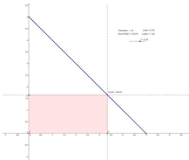
**GRÁFICO 3:** Lugar geométrico segmento de reta obtido por um dos vértices de um retângulo de perímetro 10 u.p.
