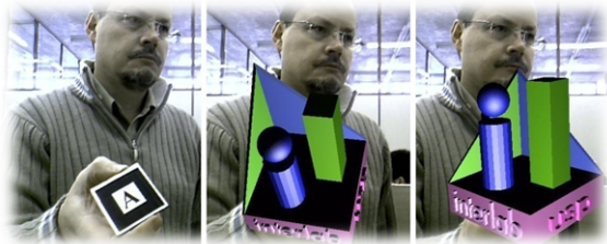
Figura 4: Uso de marcadores fiduciais para rastreamento e registro de objetos virtuais
