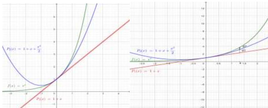
Gráfico 2 : Vista local do gráfico da função f(x) = \exp(x) conjuntamente com os polinômios de Taylor associados à ordem 1 e 2 na vizinhança de 0. d_1 representa o(x) e d_2 representa o(x^2) para x fixado vizinho de 0.
