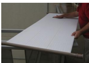
FIGURA 2. (a) O perfil de PVC extrudado. (b) Seu acoplamento com a cabeça do coletor. (c) Preparo do perfil após colagem das peças. (d) Pintura dos perfis antes de fixá-los na montagem do aquecedor.
