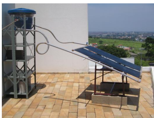
FIGURA 3. Vistas do local onde está operando o equipamento. A bancada de ensaios com os coletores solares e o reservatório em suas formas finais.
