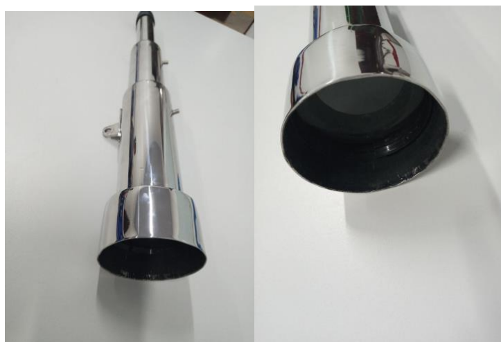
Figura 3: Luneta pronta. Acima desmontada. Abaixo esquerda montada. Abaixo direita detalhe da objetiva 17 .
