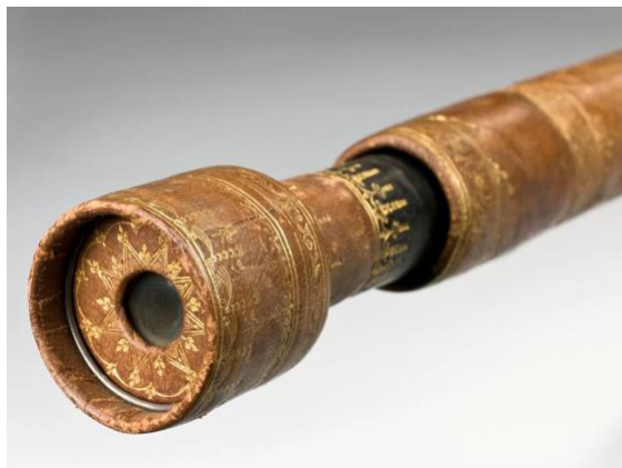
Figura 1: Perspicillum de Galileu Galilei: possui 0,927 m de comprimento e 0,06m de diâmetro. Constituído de madeira e couro. 9
