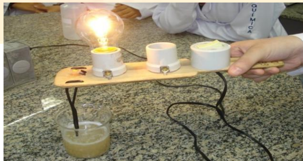
Figura 4: verificando condutibilidade elétrica da banana em solução (SILVA, 2012).
