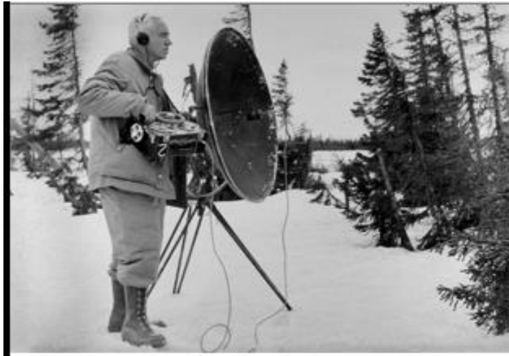
Figura 1 – Gravador portátil utilizado pelos professores Kellog e Allen, a partir dos anos 1930. Esse modelo aproveitava a tecnologia de moldes de parábola da Primeira Guerra Mundial.
