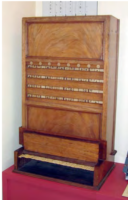
Figura 1. O “piano lógico” concebido e realizado por W. S. Jevons. (Disponível em: < goo.gl/KtzPPZ >. Acesso em: 4/set/2015).
