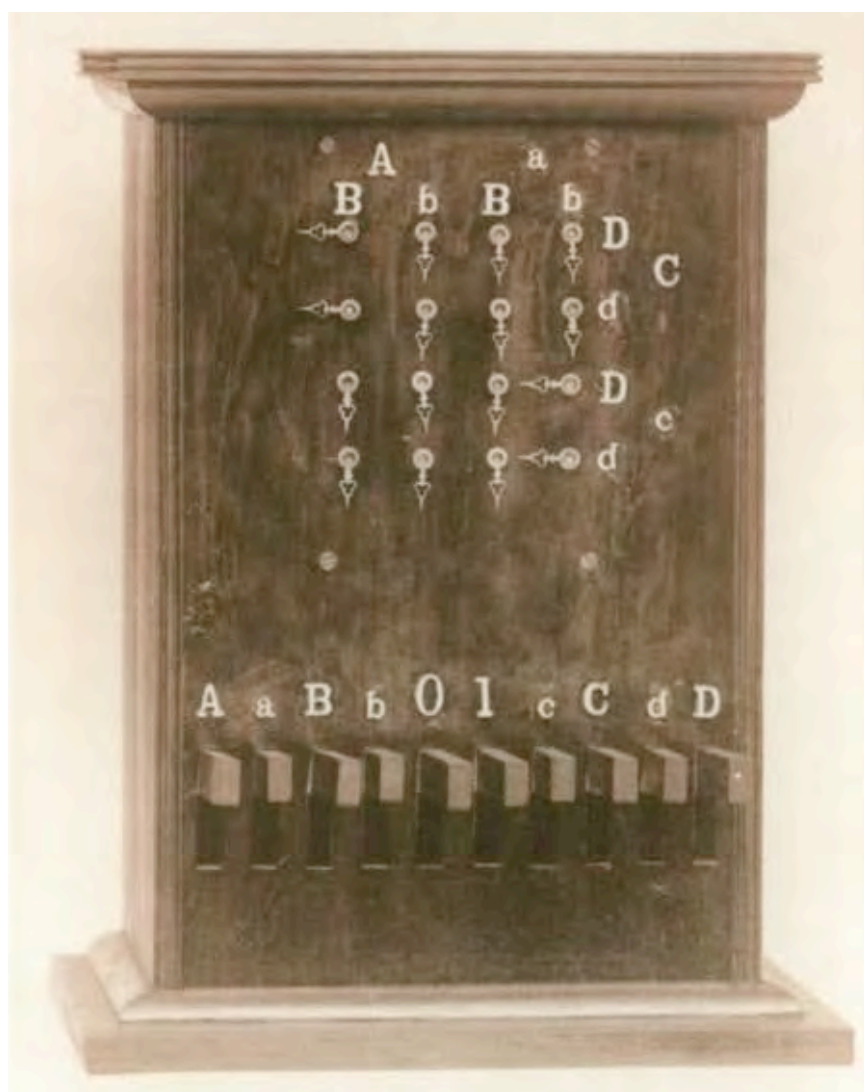
Figura 2. Máquina lógica concebida e realizada por A. Marquand. (Disponível em: <goo.gl/ctcvJx>. Acesso em 4/set/2015).
