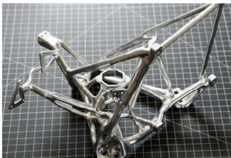
Figura 1: Suporte projetado por algoritmo genético (Henry Dennis/NASA). Disponível em: < https://shorturl.at/jkyM1 >. Acesso em: 7 set. 2023.
