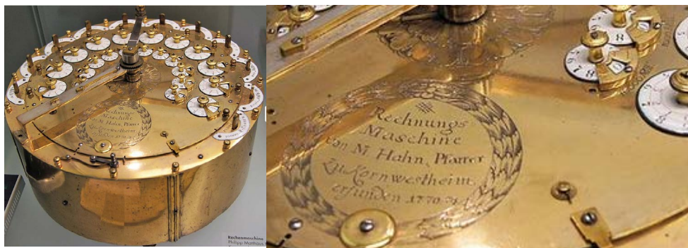
Figura 1. A máquina cilíndrica aritmética do pastor e astrônomo Philipp Mathäus Hahn (1739-1790) de Kornwestheim, exemplar do Museu do Estado de Württemberg em Stuttgart (Foto: Bernd Gross, CC BY-SA 4.0). Ela serve para fazer as quatro operações aritméticas básicas, adição, subtração, multiplicação e divisão e era construída com uma “roda de Leibniz”, um cilindro diferenciado inventado por Leibniz entre 1672 e 1694 e usado em máquinas de calcular até aos anos 1970 (ver https://en.wikipedia.org/wiki/Stepped_reckoner ).
