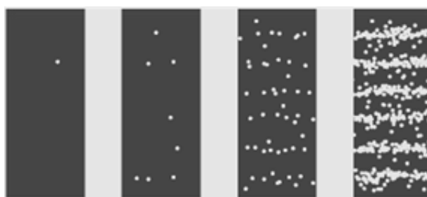
Figura 2: formação paulatina das franjas de interferência, a partir do acúmulo de detecções pontuais, associada aos fótons, ou quanta de luz. Fonte: Pessoa (2003, p. 4).
